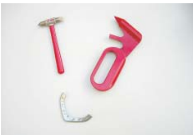
Marteaux brise-glaces utilisés dans les voitures de la SNCF. Au premier plan, pare-chocs fixés sur les skis.
